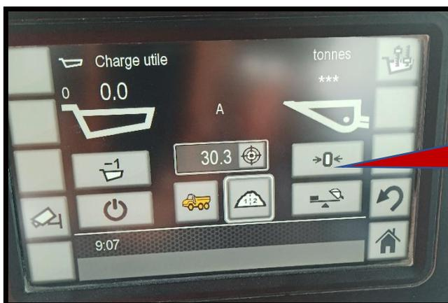
Godet fermé, lever l'équipement en maintenant un régime moteur de 1500 tours/minute et appuyer sur l'icône de remise à zéro.
